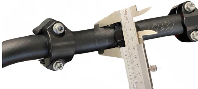
**Legen Sie die Halterung an den Lenkrohr an** und setzen Sie die 2 M4-Schrauben ein. Bevor Sie diesen Schrauben fest anziehen, empfehlen wir das Gummiband unter der Klemme um den Lenkrohr zu wickeln. Es sichert einen besseren Halt und schützt Ihr poliertes oder anderweitig behandeltes Lenkrohr vor Beschädigung. Darüber hinaus trägt die Gummipolsterung dazu bei, Vibrationen zu dämpfen. Anschließend können Sie das Gerät installieren, das Sie für die Konsole ausgewählt haben.
